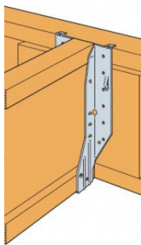
Fixação IUSE em suporte de viga em I com blocos de reforços
