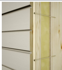
Assemblage de montants pour la réalisation d'ITE
