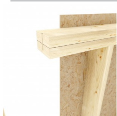
Fixation de ceinture périphérique sur la lisse haute
