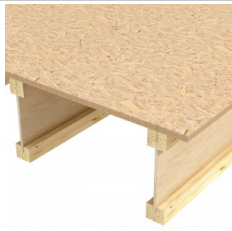
Verbinding van vloerplaten op dwarsbalken
