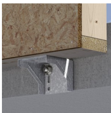
Holzkonstruktion auf dem Konsolwinkel an der Deckenschmalseite.
