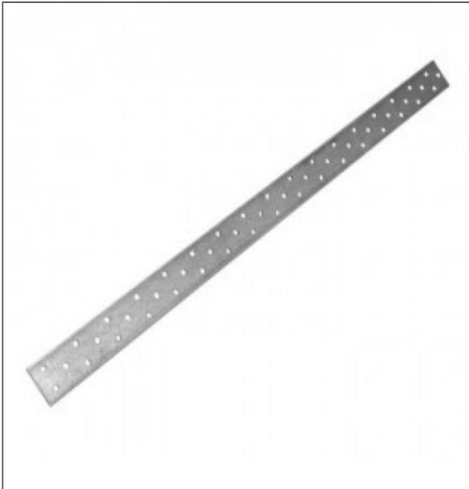
Die NP Lochbleche werden aus sendzimirverzinkten Blechen in den Dicken 1,5 mm, 2,0 mm, 2,5 mm und 3,0 mm hergestellt. Der Lochdurchmesser beträgt 5 mm.
