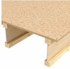
Montage - OSB- Platten auf EWP-Trägern
