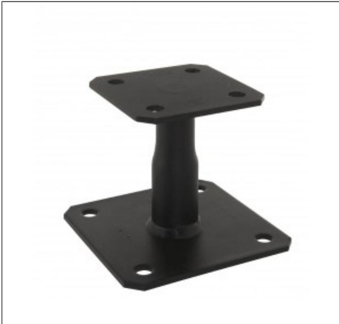
APB100/150PB Stützenfüße sind für Stützen und zur Aufständigung von Wandkonstruktionen bei Holzbreiten ab 100mm Breite geeignet. Eine Höhenverstellung ist im Bereich von 100-150mm möglich.
