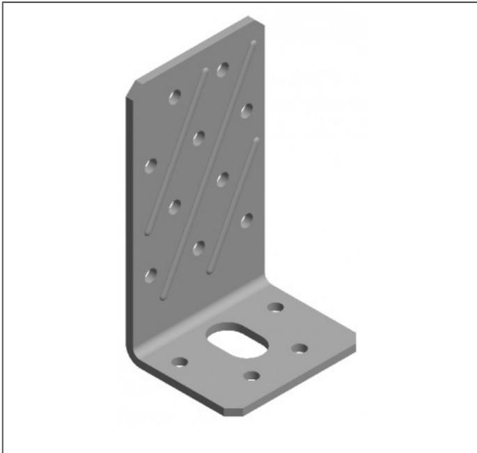
Der Winkelverbinder ABD45100 ist für Holzanschlüsse an Holz und in Kombination mit der passenden Unterlegscheibe US40/50/10-B für Anschlüsse an Beton geeignet. Anschlüsse an Beton erfolgen mit M12 Ankerbolzen.
