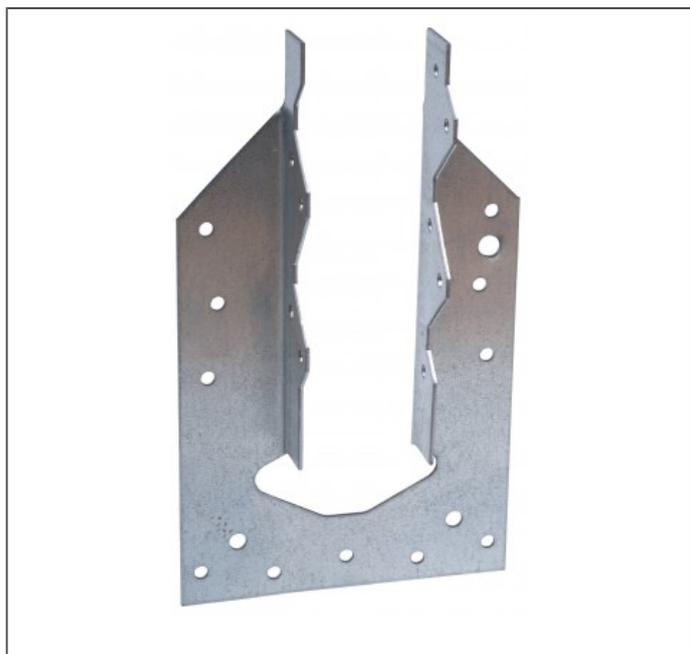
Le pied de chevron PFP permet de raccorder un chevron avec la sablière à un poteau. Il assure ainsi la reprise du soulèvement des fermes situées au droit des pignons.
