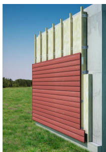
Mise en place d'un pare-pluie
