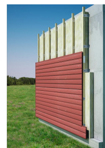
Mise en place d'un pare-pluie
