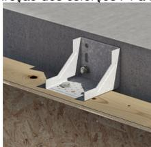
Fixação da parede por parafusos na parte superior, no rebordo da laje. Direção dos esforços: F5 = 5 kN
