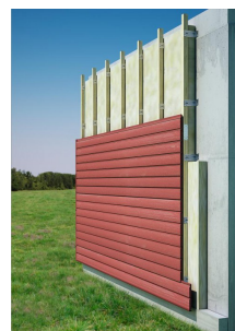
Mise en place d'un pare-pluie
