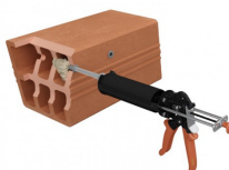
4. Vullen vanaf bodemgat naar buiten door bij het pompen telkens één maatstreek op de spuitmond achteruit te gaan.
