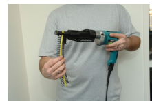
6. Insérez la bande de vis, pointe dirigée vers le haut : votre visseuse est prête !
