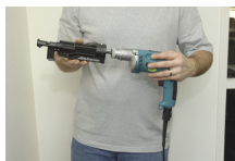
5. Engagez le chargeur sur le mandrin et enclenchez-le sur l'adaptateur.
