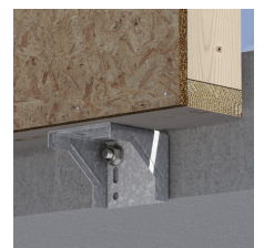
Asennus puuelementin pohjaan
