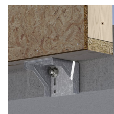
Fijación de la pared en la parte inferior, en la cara de la losa
