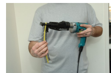
6. Insertar la cinta de tornillos, punta hacia arriba : ¡su atornillador ahora es listo para funcionar!
