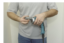
3. Instalar el adaptador
