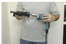
5. Empeñar el cargador sobre el mandril y engranarlo sobre el adaptador.
