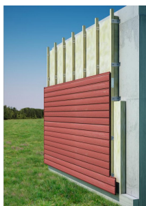
Montering af beklædning
