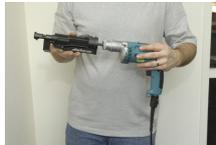
5. Stecken Sie den Schraubervorsatz auf den Adapter und lassen Sie ihn darauf einrasten.
