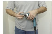
3. Montieren Sie den Adapter auf den Schrauber.
