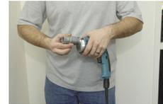
3. Montieren Sie den Adapter auf den Schrauber.
