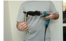
6. Setzen Sie den Schraubengurt mit der Spitze zuerst in den Schraubervorsatz ein. Damit ist Ihr Elektroschrauber einsatzbereit!
