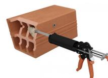
Vor dem Injizieren: Mörtel auspressen bis dieser eine einheitliche hellblaue Färbung aufweist. Mörtelvorlauf (min. 3 Hübe) verwerfen! Mörtel vom Bohrlochgrund aus hubweise injizieren bis 2/3 des Bohrlochs verfüllt sind.
