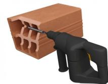
Bohrloch hammerbohend erstellen. Durchmesser und Bohrtiefe beachten.
