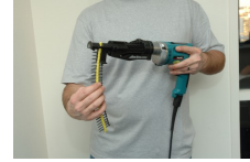
6. Insérez la bande de vis, pointe dirigée vers le haut : votre visseuse est prête !
