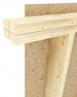
Fixation de ceinture périphérique sur la lisse haute
