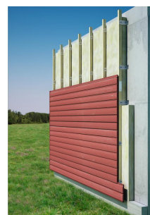
Mise en place d'un pare-pluie
