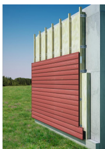
Mise en place d'un pare-pluie
