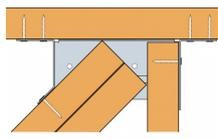
ETC434 Assemblages 2 éléments 1 arêtier double - 1 empannon
