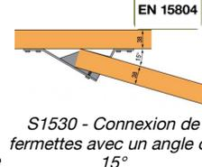
S1530 - Connexion de fermettes avec un angle de 15°
