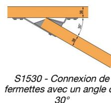
S1530 - Connexion de fermettes avec un angle de 30°
